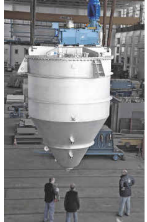
Im großvolumigen Vertikalmischer werden verschiedene Cellulosederivate homogenisiert
