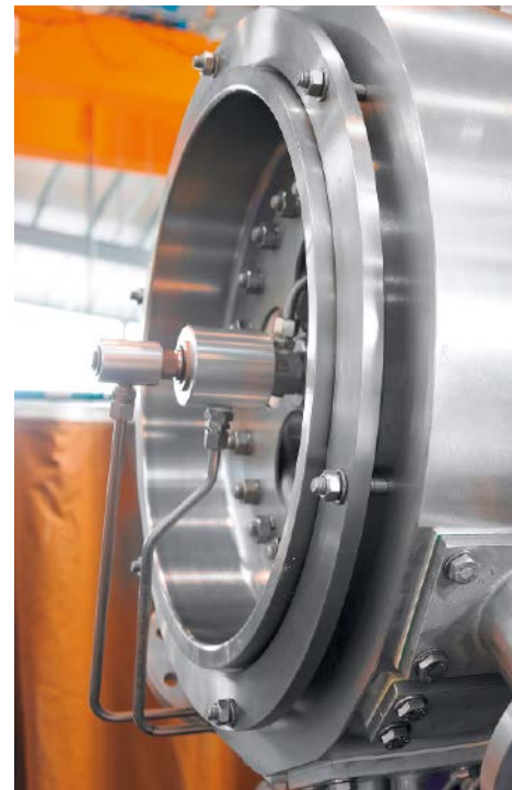
Abb. 2: Stirnradfilter vom Typ RPF B16 mit einer aktiven Filterfläche von 5,8 m 2 für einen Suspensionsdurchsatz im kontinuierlichen Betrieb von bis zu 25 m 3 /h
