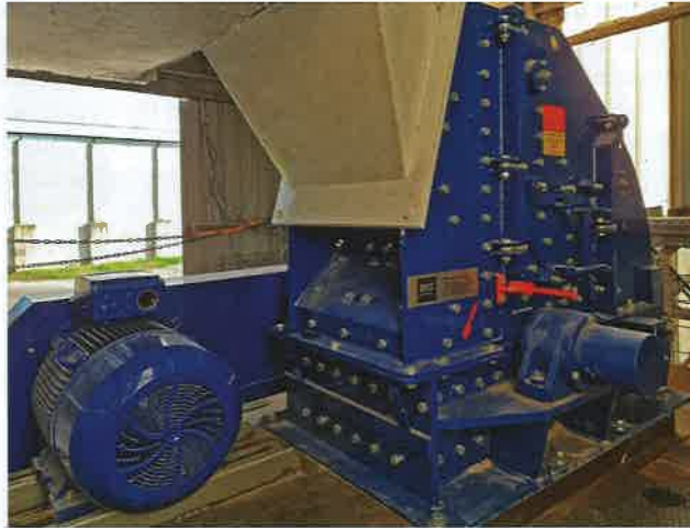
1 Der Prallbrecher des Typs PB 0806 von BHS-Sonthofen verarbeitet zwei verschiedene Arten von Perlit für die Saftindustrie
