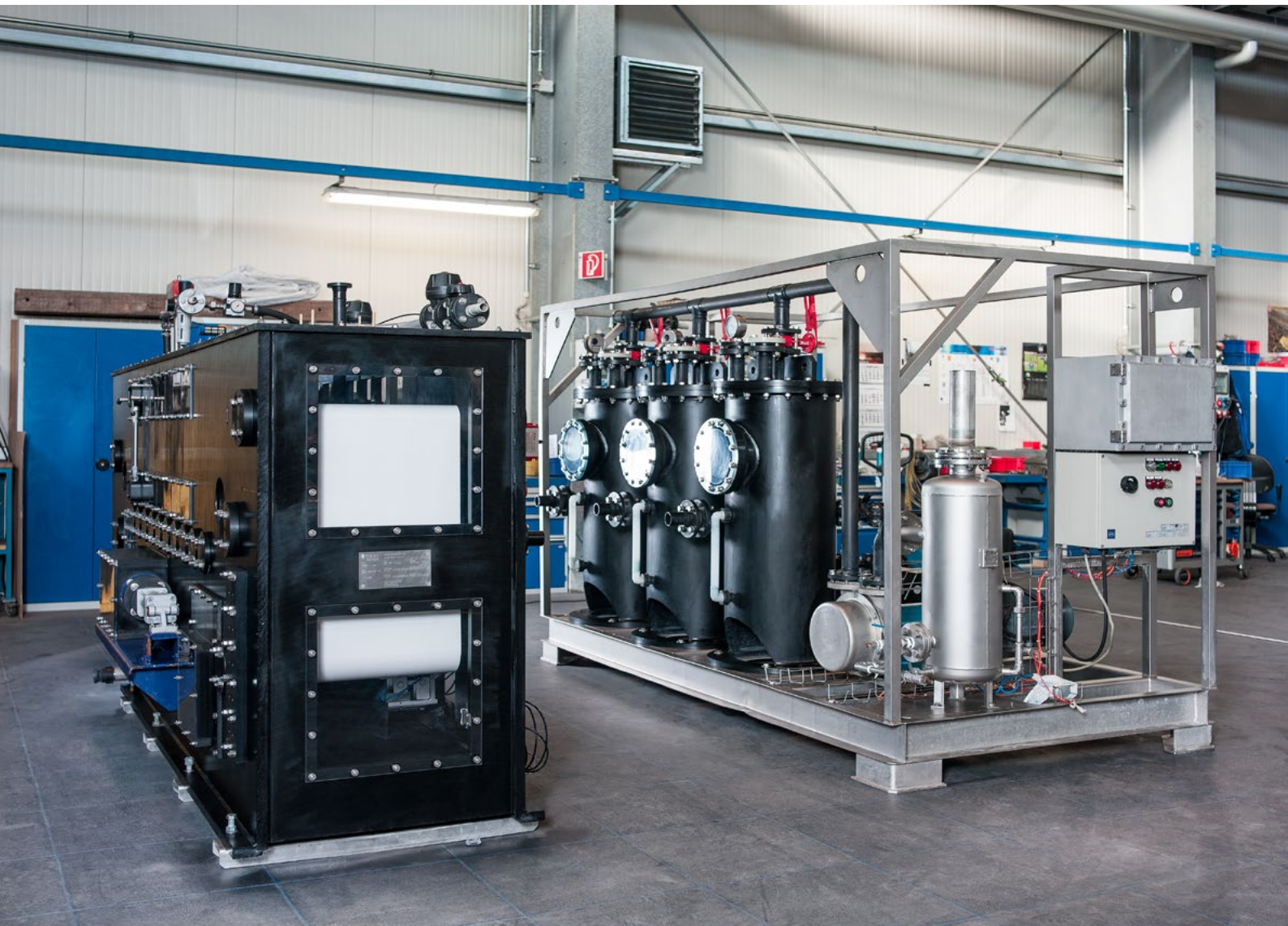
Pilotbandfilter-Anlage in geschlossener Kastenausführung für Versuche
